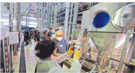
Verfahrenstechnik an der Technischen Hochschule in Nürnberg: Im Labor werden durch Verdampfen Ethanol und Wasser voneinander getrennt.
