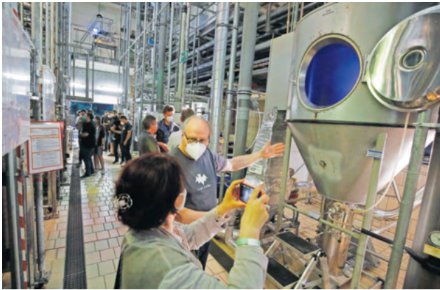
Verfahrenstechnik an der Technischen Hochschule in Nürnberg: Im Labor werden durch Verdampfen Ethanol und Wasser voneinander getrennt.
