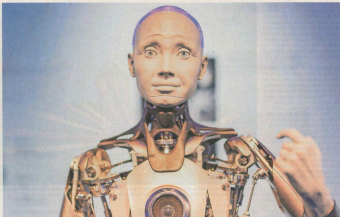
Ameca, hergestellt von Engineered Arts, soll Aufsehen erregen, dient aber auch zu Forschungszwecken. Vor allem die Mimik und Gestik von Ameca sorgen für Erstaunen. Bewegt wird sie von 52 Motoren. Laufen kann sie nicht, sie wird fest installiert im Foyer stehen, an einer Wand hinter ihr gibt es Schautafeln zu dem humanoiden Roboter.
